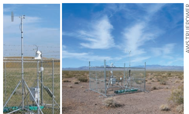
FIGURA 5.2 » Configuração típica de estação solarimétrica padrão EPE.
